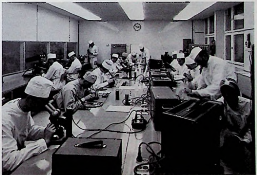
▲ Bild 1. „Cleanroom“ für Mikro-Elektronik bei SEL (Klasse 10 000 nach Federal Standard 209)
