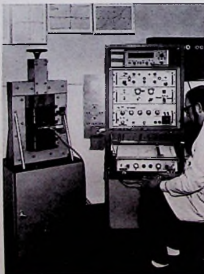
Bild 1. Mit dem im Forschungsinstitut der Fried. Krupp GmbH, Essen, entwickelten Meßgerät lassen sich die Eigenschaften hart- und weichmagnetischer Werkstoffe mit hoher Genauigkeit messen. Foto: Krupp
